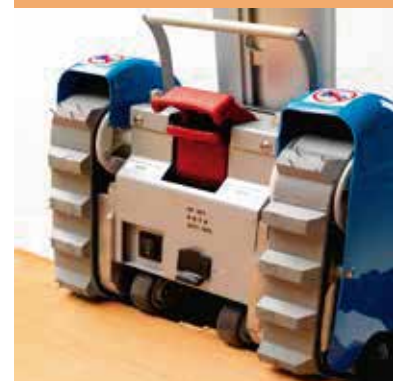
Doble bloque, eléctrico y mecánico, del acoplamiento.
